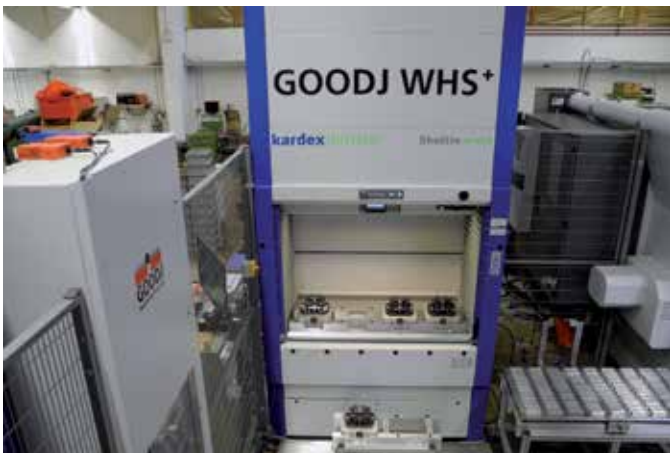
Im Turmspeicher lagern Vorrichtungen und Paletten, rückseitig ist er ebenfalls zu beladen.
