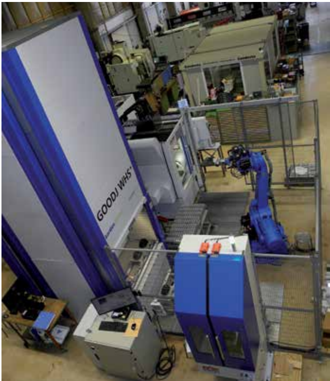
Die Komponenten der Automationslösung im Überblick: Links der Turmspeicher mit dem Bedienpult davor, dahinter das 5-Achs-Bearbeitungszentrum FZ 12 FX von Chiron, rechts davon der Roboter, vorne rechts die Rüststation.
